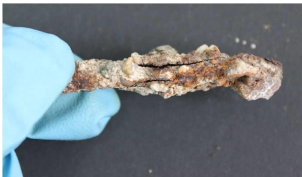
Efecte ale coroziunii asupra unor piese arheologice din fier
