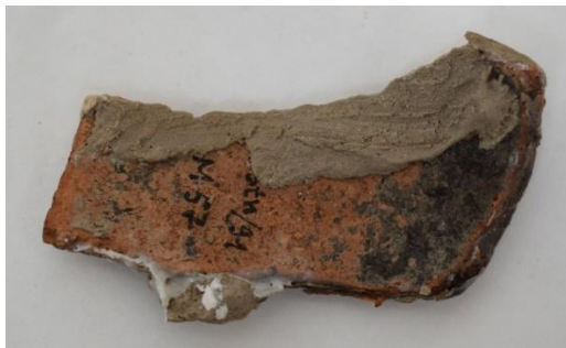
Fig. 7. În timpul restaurării (fragment cu depuneri de săruri insolubile, cu pete de adeziv și ghips)
