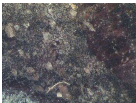
Degradări produse de factori biologici asupra învelitorii din piele- imagine obținută la stereomicroscop
