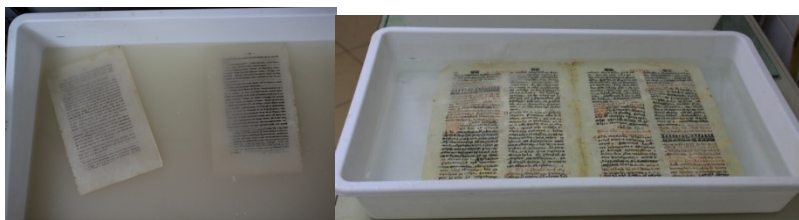
Hârtie din fibre vegetale în timpul curățării umede, prin imersare în soluție hidroalcoolică
