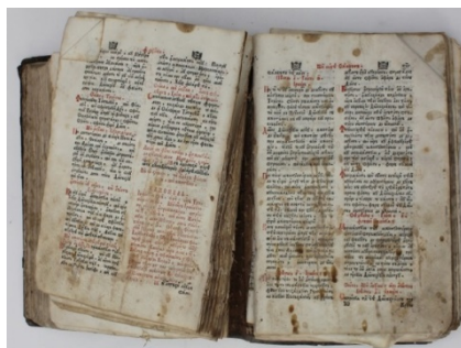
Foto.2 Desprinderea blocului de carte de pe cotor, în urma pierderii proprietăților adezivului
