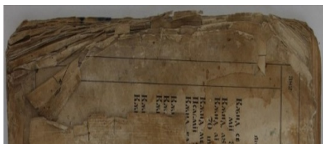
Foto.1 Modificarea nuanței hârtiei (îmbrunare), fragilizare, îndoire, pierderi materiale
